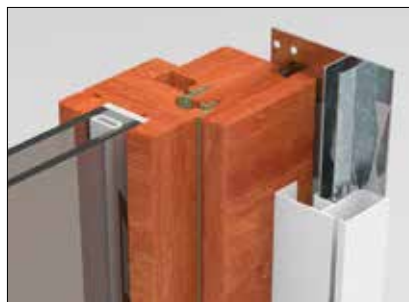
Staffa Modello2 in alluminio per fissaggio laterale all'infisso
