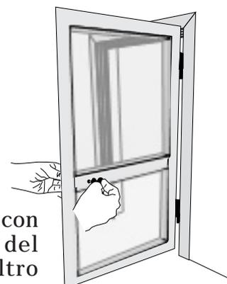
**3** Inserire l'anta della zanzariera sulle due cerniere.
