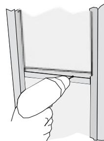
**2** Forare e fissare con viti e tasselli da 6mm, sui due lati verticali del telaio così come indicato con le lettere a, b, c, d in figura.
