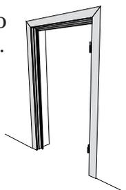
**4** Forare con punta da 4 mm il traverso dell'anta della zanzariera, dal lato interno fino all'esterno, ad una distanza voluta per posizionare poi il pomello di apertura.
