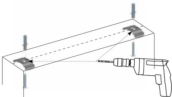
Agganciare il prodotto alle clip, così montato e forare in direzione dei fori all'interno delle guide, bloccare con le viti.
