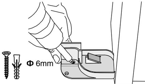
**2** Appoggiare l'attacco a muro superiore sul cassonetto. Inserire il cassonetto nell'attacco a muro inferiore precedentemente fissato
