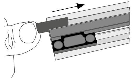
**5** Posizionare il profilo di chiusura nel vano opposto al cassonetto, effettuare tre fori di fissaggio (superiore, centrale e inferiore) e fissarlo.
