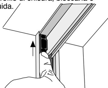
**10** Fissare con la vite in dotazione il fermaguida superiore
