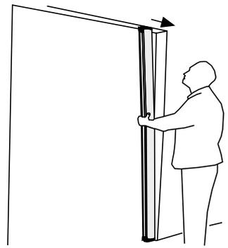
**3** Dopo la foratura inserire i tasselli e fissare con le viti apposite l'attacco a muro superiore
