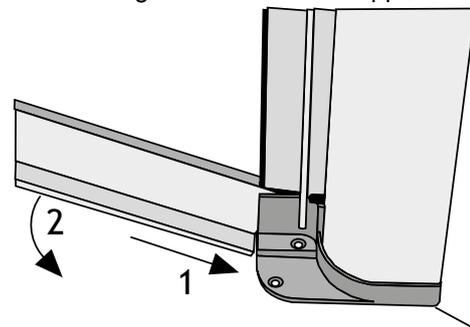
**7** Successivamente nel profilo di chiusura, bloccare la guida con i fermaguida.
