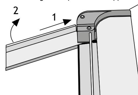
**9** Successivamente inserire l'altra estremità della guida superiore nel profilo di chiusura, bloccarla e fissarla con i fermaguida.
